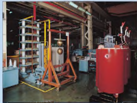
Испытание на устойчивость к импульсным перенапряжениям
