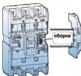
Независимый расцепитель предназначен для дистанционного отключения автоматического выключателя. Отключение происходит при подаче на расцепитель напряжения. В состав данных расцепителей входит контакт, размыкающий цепь катушки независимого расцепителя при срабатывании автоматического выключателя. Независимый расцепитель не применяется в автоматических выключателях дифференциального тока 30-250AF.
