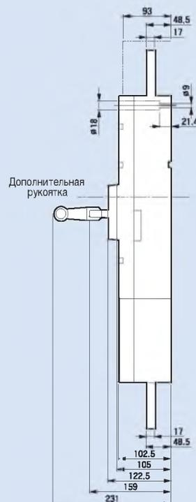
Разметка отверстий в монтажной панели
