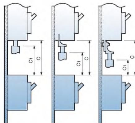
Непосредственное присоединение провода или жилы кабеля к выводу автоматического выключателя
