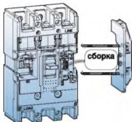
Минимальный расцепитель напряжения вызывает срабатывание автоматического выключателя, если значение линейного напряжения падает до 35 - 70 % от номинального значения. Срабатывание происходит мгновенно, после чего автоматический выключатель невозможно перевести во включенное положение до тех пор, пока линейное напряжение защищаемой цепи не поднимется до 85 % от номинального значения.
