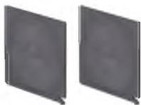
Межполюсные перегородки позволяют улучшить изоляцию между выводами автоматического выключателя, что особенно важно при увеличении размеров присоединяемых проводников. Перегородки вставляют с передней стороны автоматического выключателя в соответствующие гнезда после присоединения проводников.
