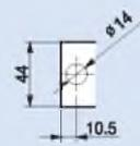
Разметка отверстий в монтажной панели
