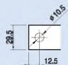
Разметка отверстий в монтажной панели
