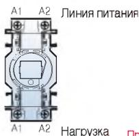
Примечание. Вывод А1 (А2) со стороны линии питания имеет внутреннюю гальваническую связь с выводом А1 (А2) цепи нагрузки.
