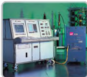
Проверка характеристик вакуумного автоматического выключателя
