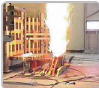
Испытание воздушного автоматического выключателя на короткое замыкание
