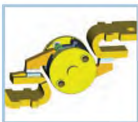
Оптимизированная форма эксцентрика
