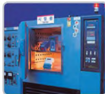
Испытание непрерывным воздействием высокой температуры
