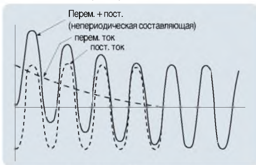
Рис. 1 Составляющие тока короткого замыкания
