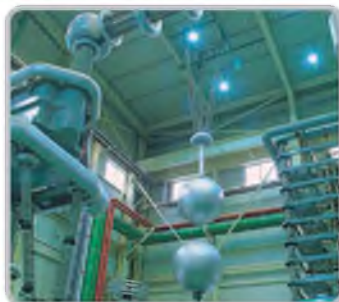
Испытание импульсом в лаборатории высоких напряжений
